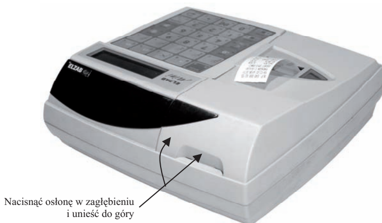
Rys. 1-2. Otwieranie osłony drukarki
