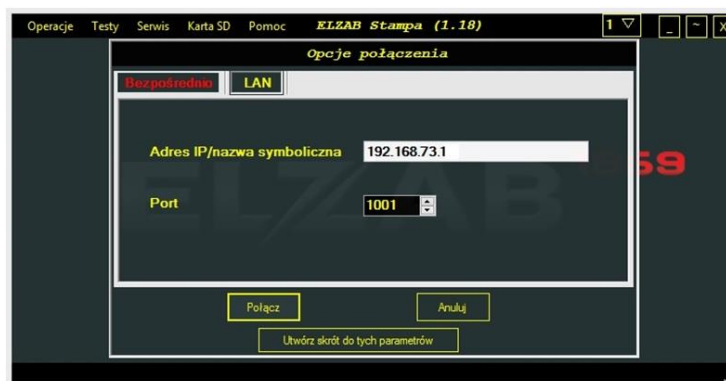
Rys2. Opcje połączenia programu Stampa – interfejs LAN
